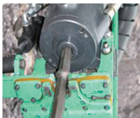
Perforateur HC 20 emmanchement hexagonal + décaleur hydraulique
